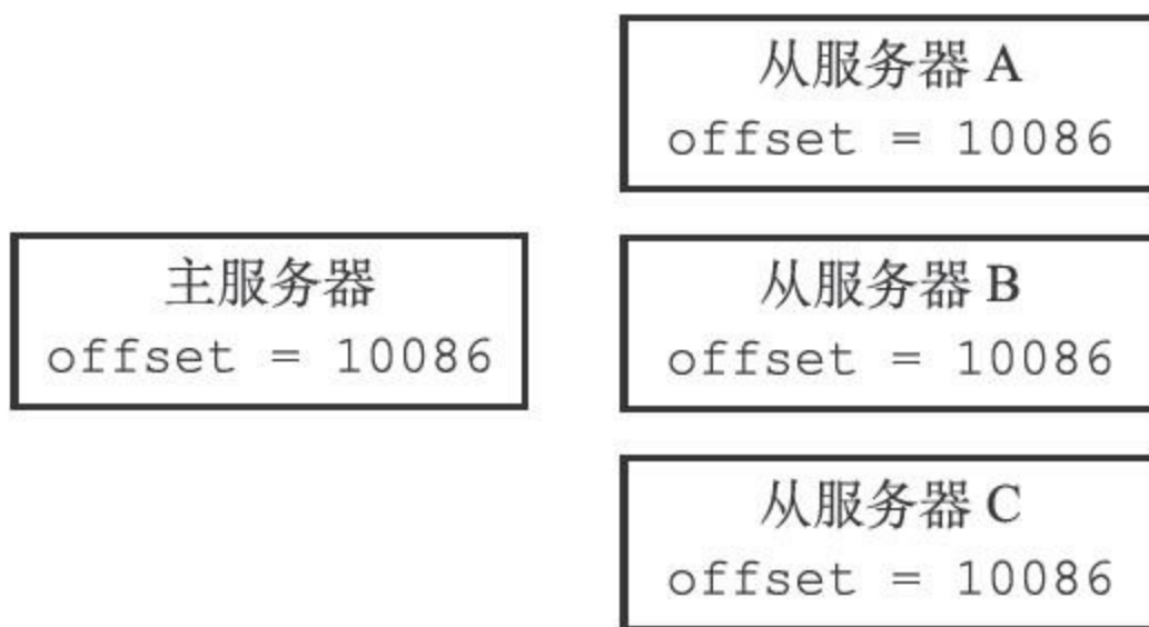
图15-7 拥有相同偏移量的主服务器和它的三个从服务器
