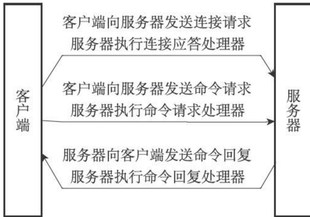
图12-7 客户端和服务器的通信过程
