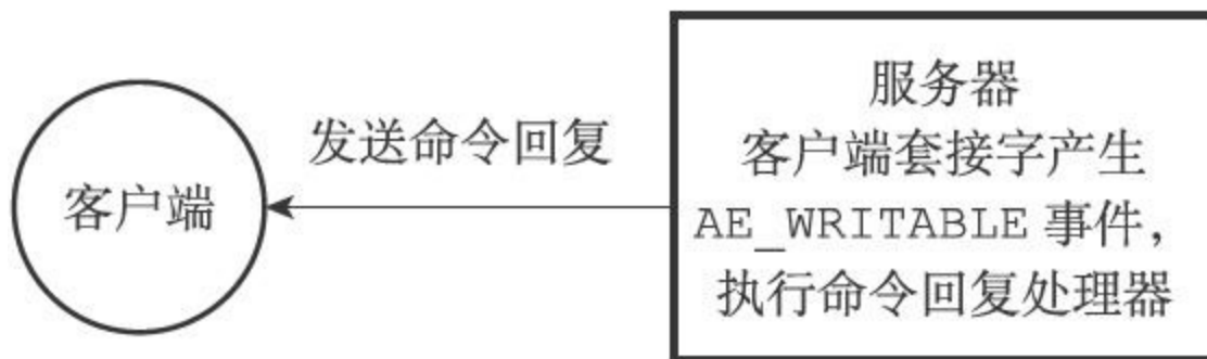
图12-6 服务器向客户端发送命令回复
