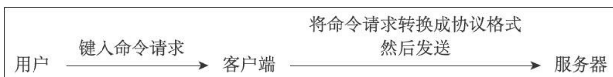
图14-1 客户端接收并发送命令请求的过程
