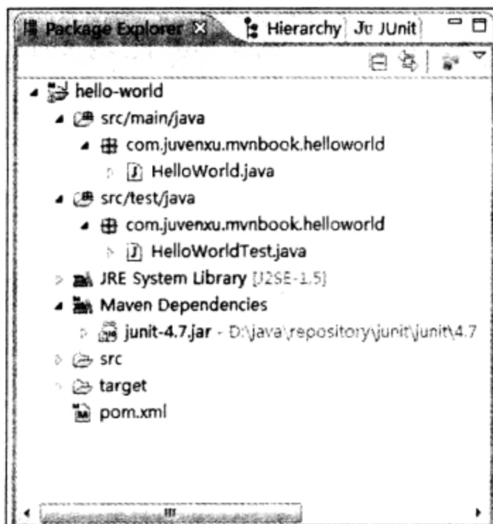
图 3-2 Eclipse 中导入的 Maven 项目结构
